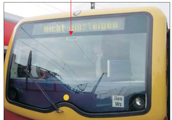
Sehr kleiner Optical Receiver hinter der Frontscheibe
