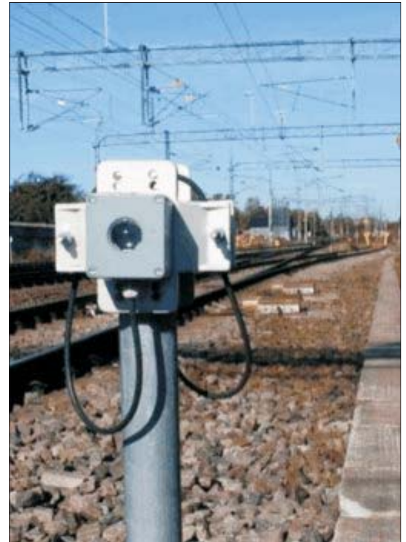
LB 200 - Einweglichtschanke in Gehäuse IP 65
