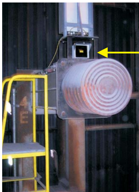
Chargierkran mit INET 100 Übertragungsbereich 1,5 m ... 350 m (Kranbahnlänge)
