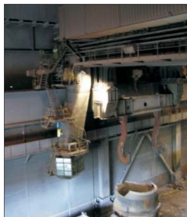
Chargierkran mit INET 100 Übertragungsbereich 1,5 m ... 350 m (Kranbahnlänge)
